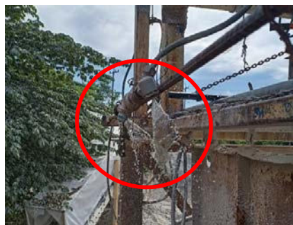
รูปที่ 2-15: ระบบสเปรย์น้ำของโรงโม่
