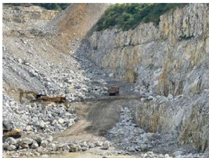
รูปที่ 2-7: การทำเหมืองแบบขั้นบันได
